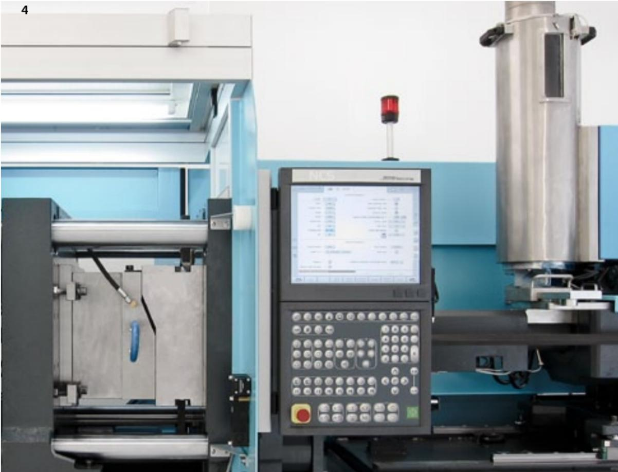
Plně elektrický vstřikovací stroj, nástroj bez maziv a laminární proudění vzduchu pro výrobu vstřikovaných dílů v podmírkách čistého prostředí
